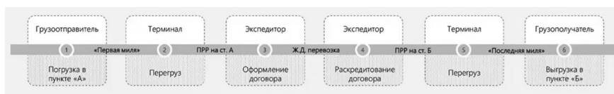
Рис. 2. Типовая цепочка услуги мультимодальной перевозки, заказ и исполнение которой предусмотрены электронным сервисом «Мультитог». Примечание: ПРР – погрузо-разгрузочные работы. Источник: [4].
