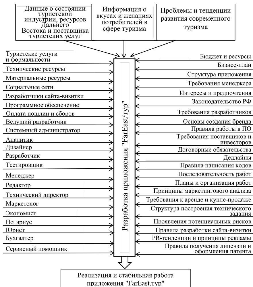
Рис. 1. 0-й уровень нотации функциональной модели IDEF0. Составлено авторами с использованием [4].
