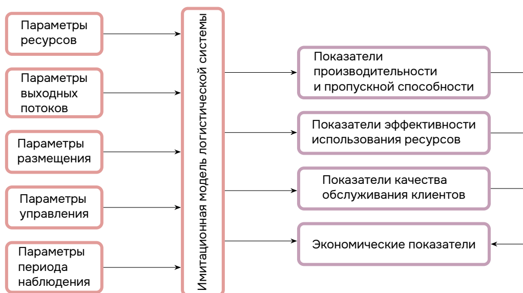
Рис. 1. Обобщенная схема имитационной модели логистической системы.
