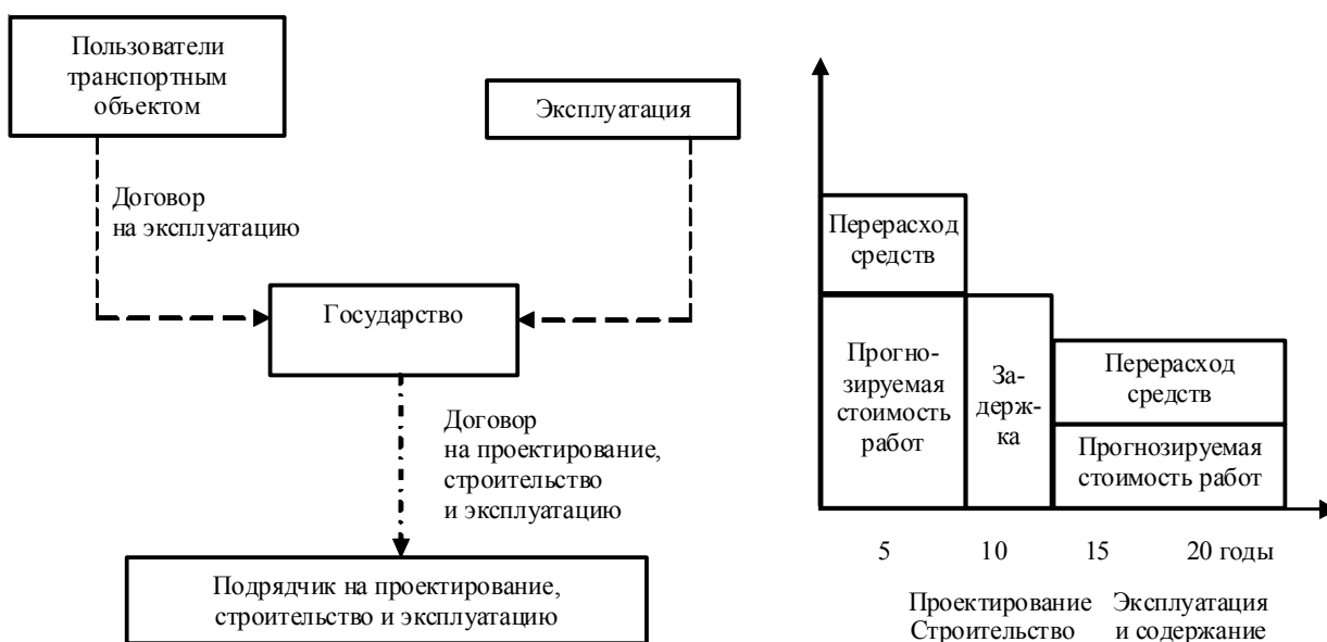
Рис. 3. Модель проектирования, строительства и эксплуатации транспортного объекта
