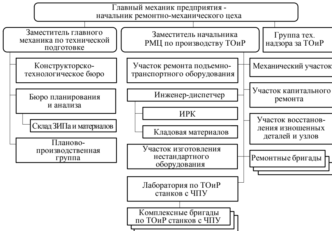
Рис. 1. ОС управления подразделением технического обслуживания и ремонта оборудования на предприятии типа А:
